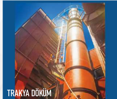
TOŞÇELİK KİREÇ FIRINI Tosyalı Tesisine 2 adet 650 ton/gün kapasiteli kireç tesisi ve 1 adet 650 ton/gün kapasiteli dolomit tesisi imalat ve montajı yapılmıştır.
